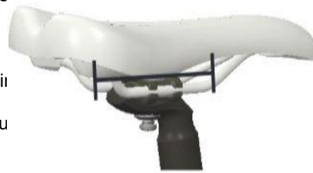
GERADER ABSCHNITT DER SATTELSTREBEN
